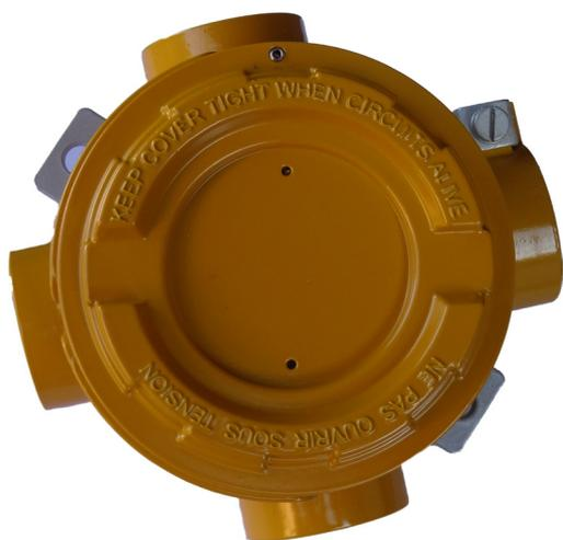
Caja de conexiones antideflagrante fabricada en aluminio exento de cobre, lo que le confiere una gran resistencia mecánica. Incorpora una tapa redonda roscada, tornillería de acero inoxidable y barra de sujeción.
