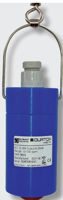
DURTOX NH<sub>3</sub> DE LARGA EXPOSICIÓN (0-100ppm) está disponible en formato 4-20mA y envoltorio plástico cilíndrico. De bajo coste de mantenimiento y fácil instalación, es compatible con la central DURGAS mediante interface de conversión (4-20mA a RS485) lo que permite aumentar su distancia de instalación hasta los 1000m.
