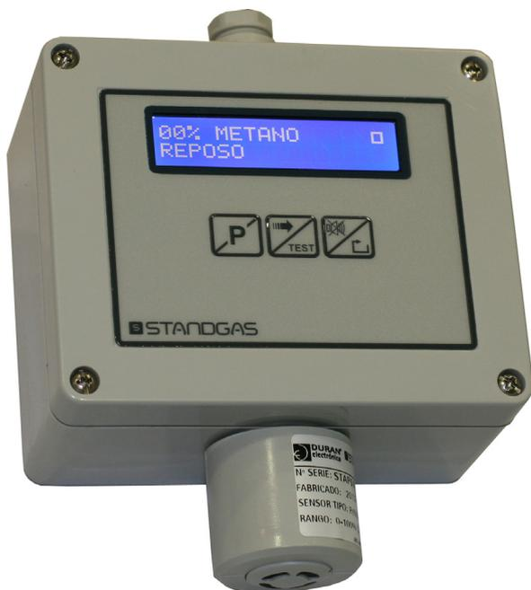
Detector autónomo programable diseñado para la detección de gases explosivos con tecnología catalítica (pellistor), para un rango de detección de 0 a 100% L.I.E. y resistente a los vapores de siliconas.
