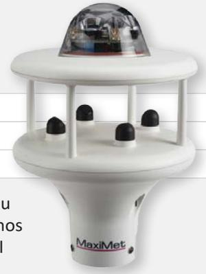
**Precipitación.** Un pluviómetro óptico integrado que detecta automáticamente el agua que golpea su superficie exterior y proporciona mediciones basadas en el tamaño y el número de gotas. Los algoritmos interpretan estos datos y simulan la salida de un pluviómetro de volcado en un formato de serie. El pluviómetro óptico no tiene partes móviles asociadas con cubetas basculantes.
