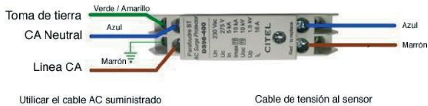
Figura 5.3.4-1 Cableado del módulo de protección contra sobretensiones
