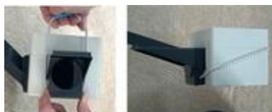
Fig. 4.1-1 Instalación del filtro ND 4
