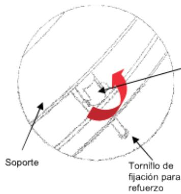
1°. La pieza móvil en la que enrosca el tornillo se gira 90° aproximadamente hacia derecha o izquierda.
