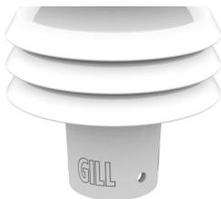
Idealmente, el usuario debería tratar de mantener las pantallas de radiación MaxiMet limpias y libres de crecimiento biológico, pero una simple limpieza con un poco de detergente suave y no agresivo será suficiente. No se deben usar solventes, y se debe tener cuidado para evitar rayar cualquier superficie. Se debe permitir que la unidad se descongele naturalmente después de exponerse a la nieve o condiciones heladas, NO intente quitar hielo o nieve con una herramienta.
