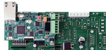
Le module INTEGRA II MODBUS de la centrale DURGAS permet d'accéder aux données internes de la centrale correspondant à chaque détecteur, et également d'ordonner une série de commandes sur la centrale, certains détecteurs et/ou groupes. Deux types de protocoles d'accès — les deux reposant sur MODBUS — permettent de réaliser ces fonctions.
