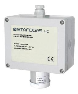
**Détecteur autonome** conçu pour la détection de gaz explosifs par technologie catalytique (pellistor) pour une plage de détection de 0 à 100 % LIE et résistant aux vapeurs de silicones.
