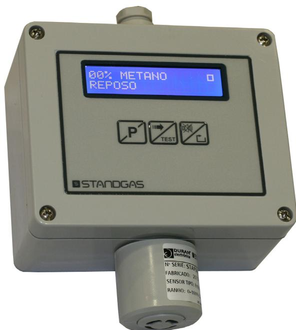
Détecteur autonome programmable conçu pour la détection de gaz explosifs disposant de la technologie catalytique (Pellistor) pour une plage de détection de 0 à 100 % LIE et résistants aux vapeurs de silicones.
