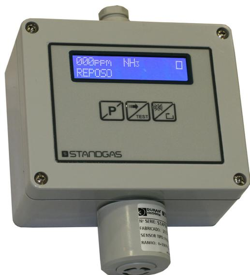
Détecteur autonome programmable conçu pour la détection de gaz toxiques et de O<sub>2</sub> par technologie électrochimique, et pour celle de CO<sub>2</sub> et de gaz réfrigérants de degré de sécurité A1 par technologie infrarouge avec technologie infrarouge et détection précoce de l'H<sub>2</sub> dans les salles des batteries.
