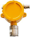
**IMPORTANT** – Instructions relatives aux entrées de câble (presse-étoupes) pour les détecteurs ATEX : l'utilisateur devra s'assurer de fixer le câble de manière adéquate. Le couple de serrage minimal qui s'applique au capuchon est de 20 Nm. Vérifiez le serrage des entrées de câble lors de chaque opération de maintenance. Si le câble a bougé, serrez de nouveau le capuchon. Si le serrage ne marche pas, renvoyez le détecteur complet à l'usine pour remplacer l'entrée du câble.
