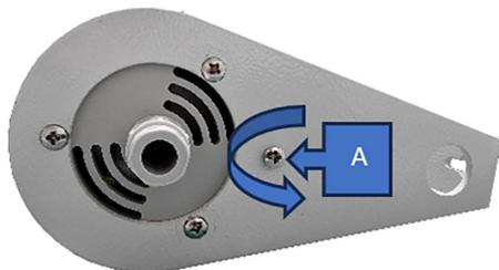
**1º** Mediante una llave Allen de 3mm, afloje el tornillo de bloqueo **(A)** que permite abrir el detector girándolo al contrario de las agujas del reloj.
