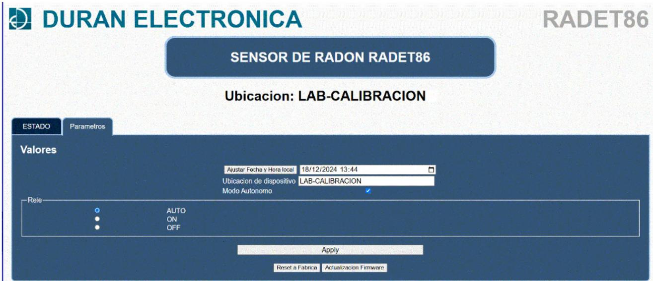
Parámetros: Ajustar fecha y hora, Asignar ubicación del detector, modificar el modo de funcionamiento, autónomo o conectado a una central **DURGAS**, seleccionar los distintos estados del relé AUTO-ON-OFF, Reset de fábrica y actualización de firmware. Cuando modifique algunas de las opciones confirme con Apply., [para actualizar el firmware del equipo consulte la pág. 11 y siga la instrucciones.](#)
