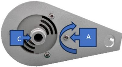
**9º** Finalmente apriete el tornillo de bloqueo (A) con una llave Allen de 3mm. y la tuerca del prensaestopas (C) girándolos a favor de las agujas del reloj.
