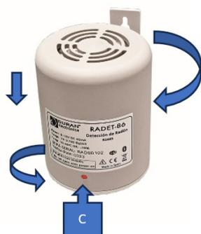
**8º** Para cerrarlo posicione el cuerpo sobre el soporte con el led (C) y la etiqueta de características al frente. Gire ligeramente a la izquierda hasta que encaje en la base. Finalmente gire a favor de las agujas de reloj hasta que haga tope.
